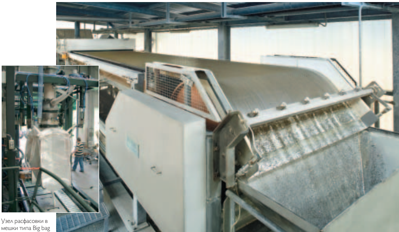
Установка Ротоформ для грануляции серы и смеси серы с бентонитовыми глинами
