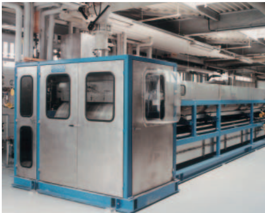
Линия с предварительным охлаждением для агрохимикатов
